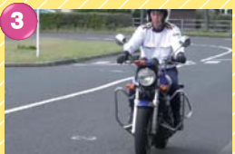
3 前輪ブレーキをかける 前輪ブレーキはあくまで「じわーっ」とかける。止まる寸前にゆるめないようにする。 (前のサスペンションがのび、ハンドルが不安定になるため)
