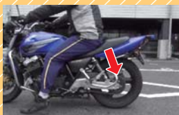
後輪ブレーキをかける 前後サスペンションが縮み、車体全体が低くなり安定します。
