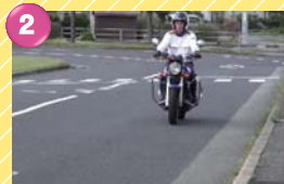
2 後輪ブレーキをかける 後輪ブレーキを前輪ブレーキより一瞬早くかけることにより、車体全体が低くなりさらに安定する。
