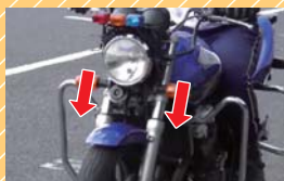
前輪ブレーキをかける 前のサスペンションが縮み、後のサスペンションが伸びます。
