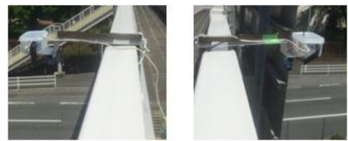
Figure 1. 福岡市での計測におけるセンサーの設置状況（横断歩道欄干への設置）。
